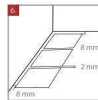
6. Aplicar las especificaciones de juntas (descrito en esta guía). Dejando una junta de 2 a 3 mm como mínimo, usando separadores. No se recomienda instalar sin junta.
