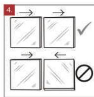
4. Coloque las piezas una a una de acuerdo al dibujo y las guías de instalación que se encuentran al reverso de cada pieza.
