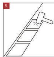
5. Asiente la pieza sobre el adhesivo, con un leve movimiento perpendicular con respecto al rayado y de pequeños golpes con el martillo de goma para evacuar restos de aire.
