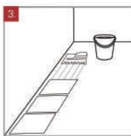
3. Aplique el adhesivo sobre el área a instalar y haga surcos con la llana dentada. Para formatos arriba de 60x60cm, se recomienda el doble encolado. Para formatos Grandes usar llana 10 a 12 mm.
