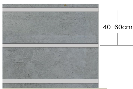
2. Instalacion de estructura de soporte
