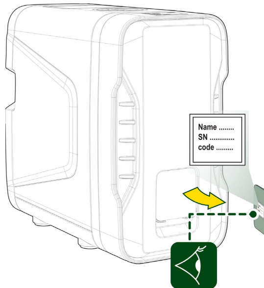
Fig. 4 Placa metálica - Posición de la etiqueta de datos básicos del producto
