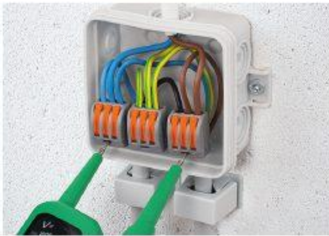
Test con voltímetro Profi-LED+ (206-806).
